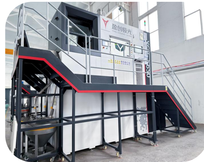
设备型号: S650 2台 成型尺寸: 650×650×1000mm 成型效率: 100cm 3 /h 设备单重: 12000kg (仅主机)
