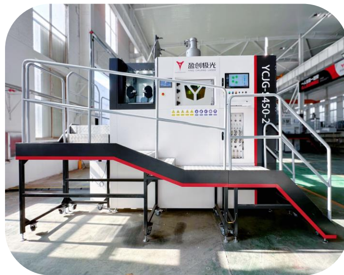
设备型号: S450 1台 成型尺寸: 450×450×500mm 成型效率: 100cm 3 /h 设备单重: 5000kg (仅主机)
